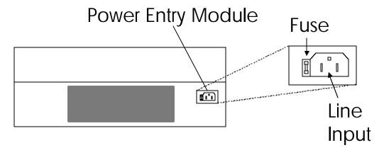
Figure 27. Power entry module
